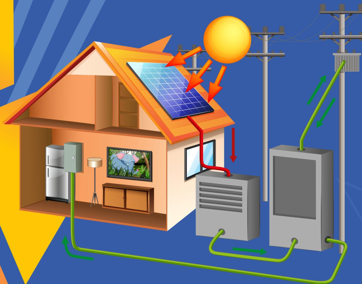
O sistema de energia solar on-grid, ou sistema fotovoltaico conectado à rede, é o sistema que permanece conectado à rede de distribuição, assim, em momentos em que não há produção de energia, é possível utilizá-la da distribuidora e, em casos de excesso de produção, recebem-se créditos de energia.
